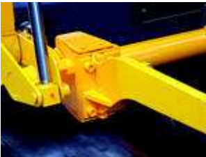
Sistema di pesatura statica per compattatore a caricamento frontale
