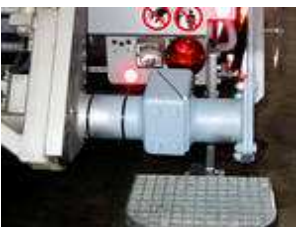
Sistema di pesatura statica per compattatore a caricamento posteriore
